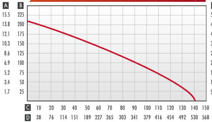
A Presión en Bar      B Presión en PSI      C Caudal en U.S. Min.      D Caudal en Litros / Min.      E Presión en Pies de altura      F Presión en Metros de altura
